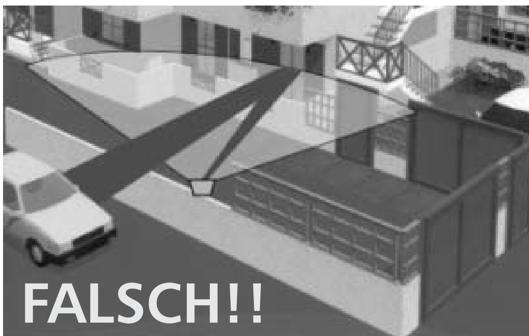
Abb. 4 Die Strahlen sollten nicht auf reflektierende Oberflächen gerichtet sein
